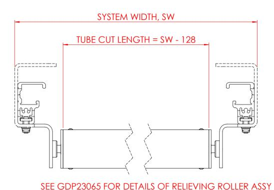
RELIEVING ROLLER TO BE FITTED TO SYSTEMS WHEN SYSTEM DRAW EXCEEDS 3000 THE RELIEVING ROLLER TO BE FITTED AT THE MID-POINT OF THE SIDEGUIDE.
