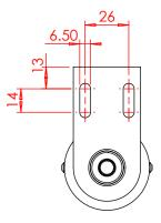
SIDE FIX BRACKET FOR HORIZONTAL TYPE SYSTEMS **USE RELIEVING ROLLER WITHOUT PULLEY**
